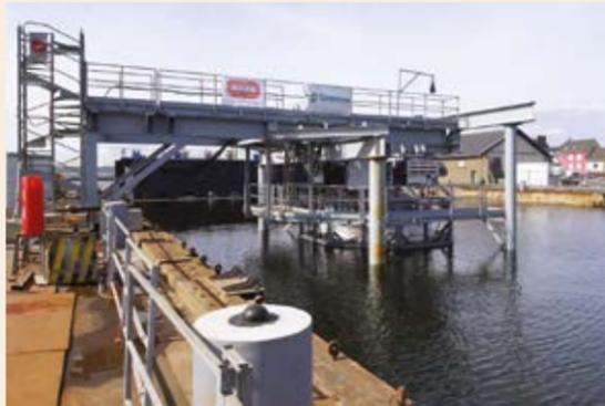
Son innovation principale, le SubSea Quieter® (SSQ), vise à limiter les nuisances acoustiques générées lors des travaux offshore (notamment le battage de pieux pour les éoliennes). Ce système, composé de panneaux souples injectés d'air, forme une barrière acoustique efficace autour des fondations en mer. Les premiers tests montrent une réduction sonore pouvant atteindre 99 %, soit jusqu'à 35 décibels. D'abord conçu pour les parcs d'éoliennes posées, le SSQ est
